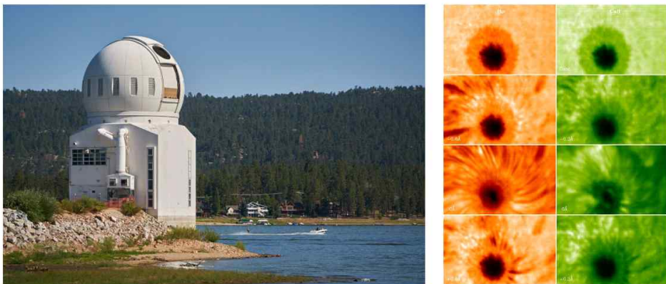
그림 42 빅베어 천문대 1.6m 태양망원경과 이에 설치된 고속영상태양분광기가 촬영한 흑점의 수소 알파선 및 칼슘선의 분광 영상 (출처: 빅베어천문대 및 한국천문연구원/서울대학교)
