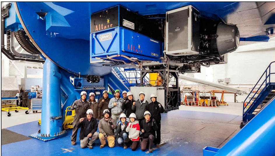
그림 18 한국천문연구원이 개발하여 제미니 8m 광학망원경에 설치한 IGRINS 근적외선 고분산 분광기 [그림 출처: 한국천문연구원]
